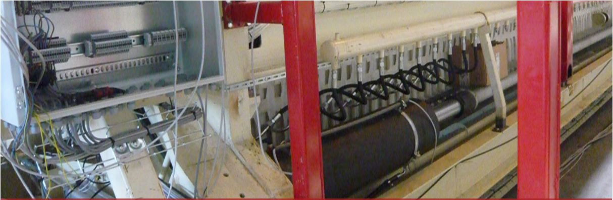
Hydraulic cylinder for sludge dehydrate Vérin hydraulique pour déshydrater les boues Hydraulikzylinder zur Schlamm entwässerung
