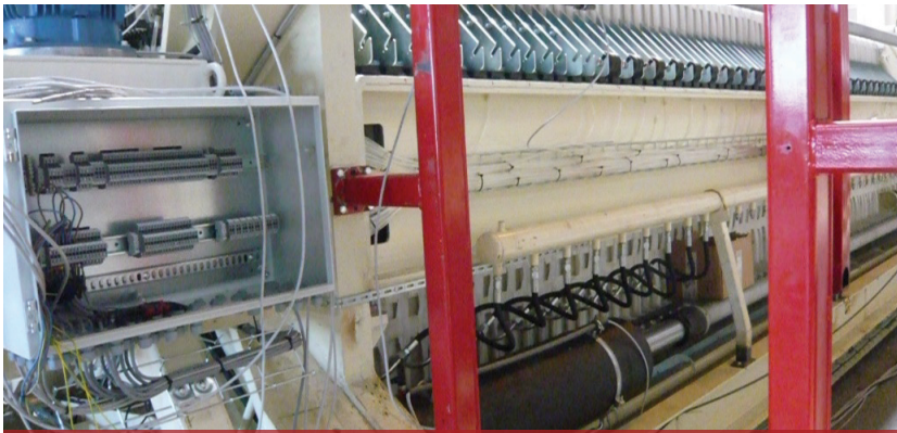
Hydraulic cylinder for sludge dehydrate Vérin hydraulique pour déshydrater les boues Hydraulikzylinder zur Schlamm entwässerung
